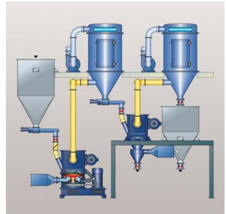
Fließbild einer Anlage zur Herstellung von Proteinkonzentraten
